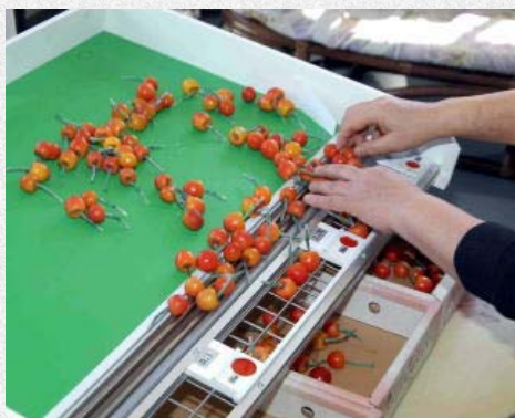
サクランボ選別作業台「早わけくん」。出荷基準に合わせてステンレス線をセットして使う。
